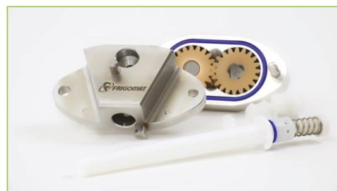
Agitatore in monoblocco in resina standard e agitatore in acciaio.
